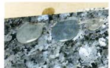
Die Farbe stimmt, aber das Leben fehlt: durchgefärbte Füllmaterialien wirken stumpf.
